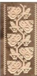
Fig. 9. Frezare la CNC prin metoda V-Carve ( v=15.000\text{rot}/\text{min} , u=6\text{mm}/\text{min} , h=1-3\text{mm} ) a. Pe lemn de paltin natur
