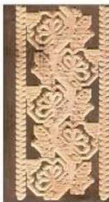
Fig. 8. Frezare la CNC prin metoda Engrave ( v=15.000\text{rot}/\text{min} , u=6\text{mm}/\text{min} , h=3\text{mm} ) a. Pe lemn de paltin natur
