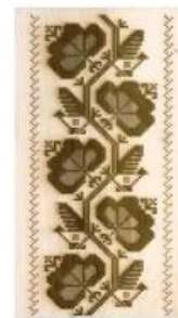
Fig. 7. Gravare cu laser (gaz de asistare azot) pe lemn de paltin, cu P=30W și 15W pentru cele două culori
