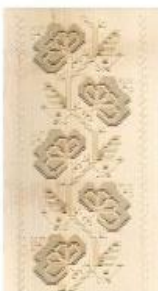
Fig. 9. Frezare la CNC prin metoda V-Carve ( v=15.000\text{rot}/\text{min} , u=6\text{mm}/\text{min} , h=1-3\text{mm} ) a. Pe lemn de paltin natur
