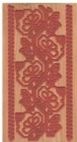
Fig. 8. Frezare la CNC prin metoda Engrave ( v=15.000\text{rot}/\text{min} , u=6\text{mm}/\text{min} , h=3\text{mm} ) a. Pe lemn de paltin natur
