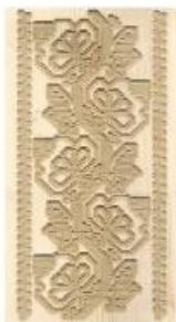
Fig. 8. Frezare la CNC prin metoda Engrave ( v=15.000\text{rot}/\text{min} , u=6\text{mm}/\text{min} , h=3\text{mm} ) a. Pe lemn de paltin natur
